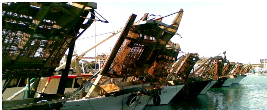
Parte della flotta di motopescherecci “turbosoffianti” in porto con le draghe idrauliche posizionate a prua
