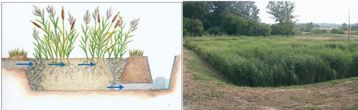
Figura 8 - esempio di impianto di fitodepurazione a flusso sommerso orizzontale (disegno IRIDRA, foto Fabio Masi)
