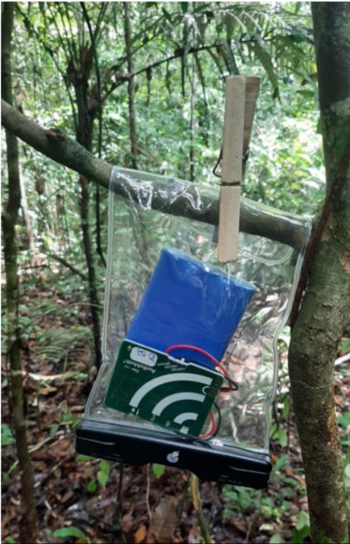
Fig. 6 - Dispositivo di registrazione pronto per il deployment sul campo. Si distinguono in verde la circuiteria del dispositivo stesso e in blu il pacco batteria, protetti da un contenitore ermetico resistente all'acqua - RFCx
