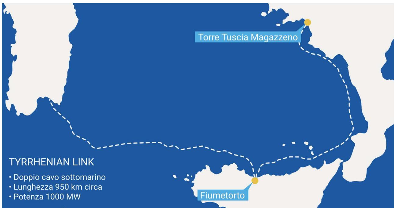
Figura 2.38 – Progetto Tyrrhenian Link (Fonte: [28])
